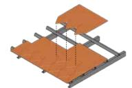
6 Lanjutkan proses pemasangan sirap dengan mengikuti pola yang telah tersusun sebelumnya hingga baris paling akhir.
