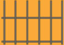
Gunakan rangka yang direkomendasikan sebagai bahan yang digunakan untuk GRC Deck Interlock. (Misalnya rangka hollow 60 x 40 x 2.3 mm, 75 x 45 x 2.3 mm, dst.). Pastikan rata dan lurus.
