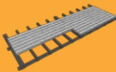
Pasang GRC Deck Interlock pada bagian paling pinggir dimana bagian "*tongue*"/"lidah bawah" berada diatas. Lakukan proses penyekrupan dengan sekrup GRC Super Panel 20 mm. Pastikan penyekrupan di area "*screw line*" yang telah disediakan.
